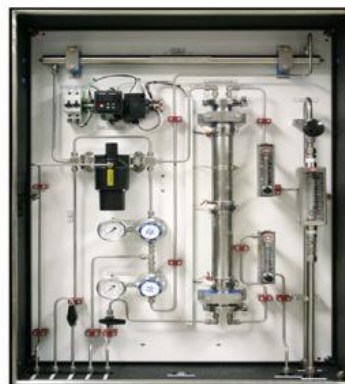
Acondicionamiento (Sensores SO 2 /NO 2 /CO 2 /O 2 )
